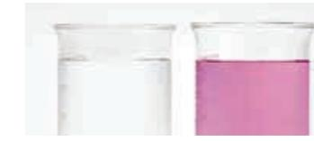
残留塩素に反応しピンク色に発色する試験薬で、浄水(左)と水道水(右)の塩素の残留量を確認する実験です。浄水(左)は塩素が除去されていることが分かります。
