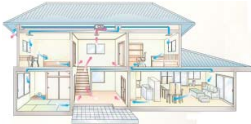
顕熱交換器により全室換気を行なう省エネ換気システム
