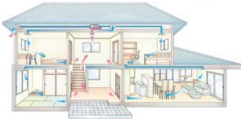
顕熱交換器により各部屋に給気を行ない 廊下で集中排気する省エネ換気システム
