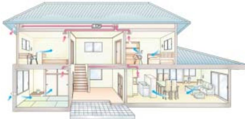
排気ファンユニットにより各部屋の排気を行ない、各部屋に設けた自然給気グリルにより自然給気を行なう換気システム
