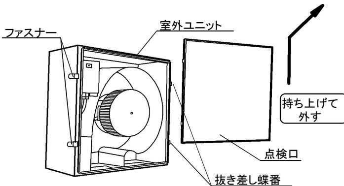
① 室外ユニット側面のファスナー(2カ所)を解除して点検口を開き、点検口を持ち上げて本体から取り外してください。
