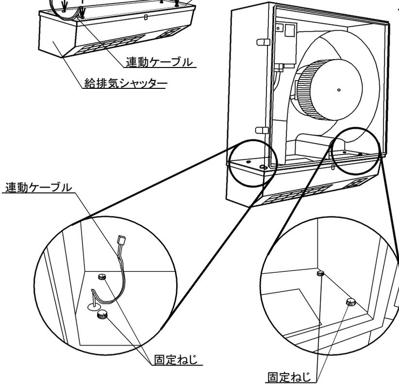
⑤連動ケーブルのコネクターを電源ボックスの空きソケットに差し込みます。
