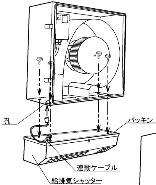
④給排気シャッターのパッキンを室外ユニット下面に押し上げながら固定ねじ(4点)で固定します。
